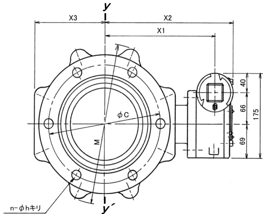
上下フランジボルト穴位置は、 $y-y'$ を基準にして振り分ける。
