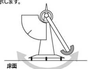
* 振り子式滑り抵抗試験 *
