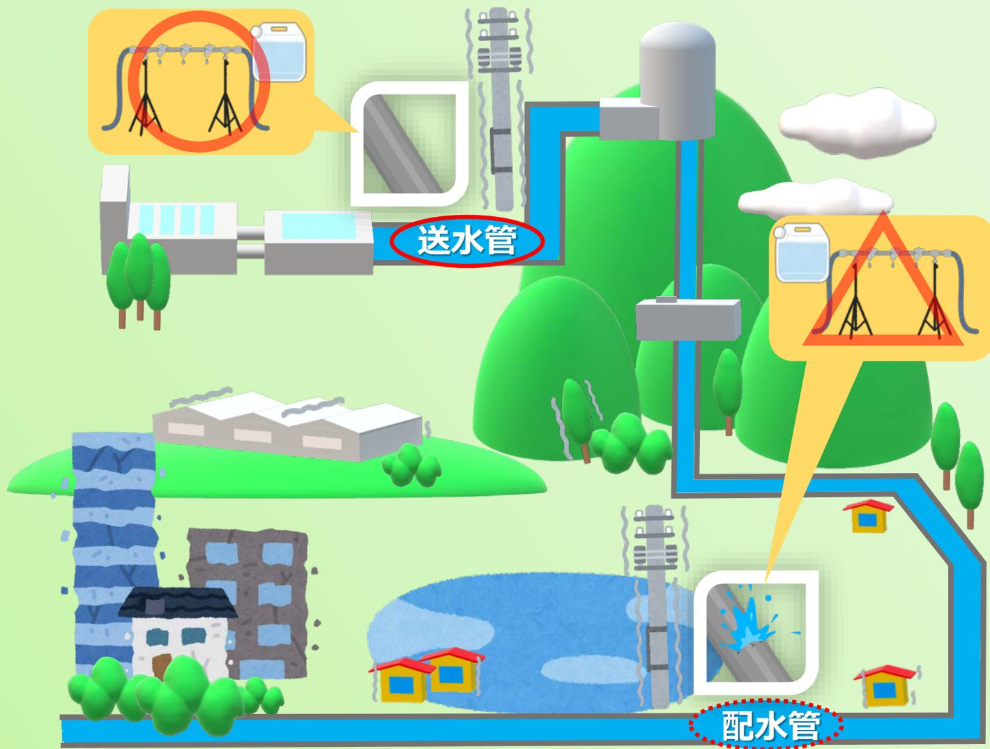
「送水管」に設置される空気弁として「給水栓付空気弁」を使用することにより**応急給水が可能**です！
