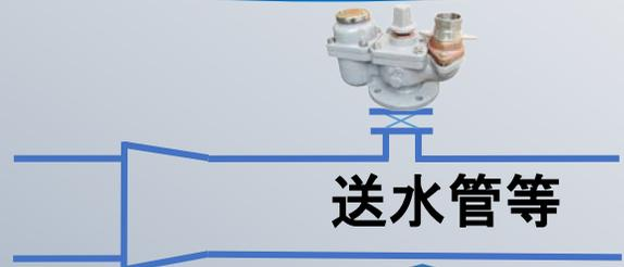
送水管に設置される空気弁として本製品を使用することにより、送水管からの応急給水を可能とするために開発致しました。
