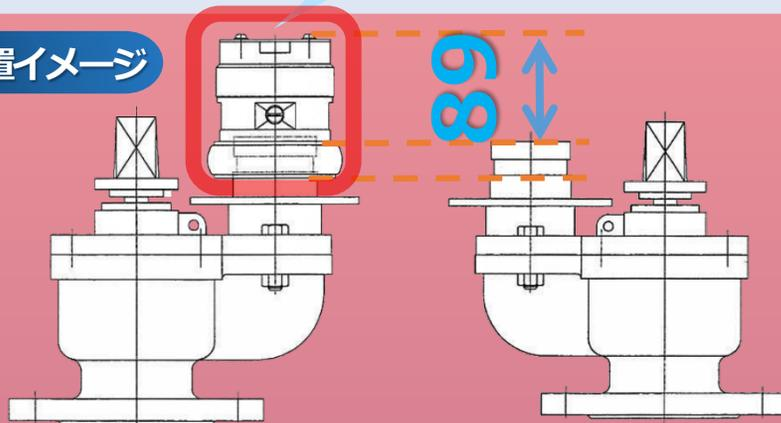
MC急速空気弁の構成
