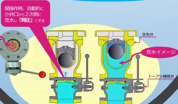
トーアツ補修弁の開閉
