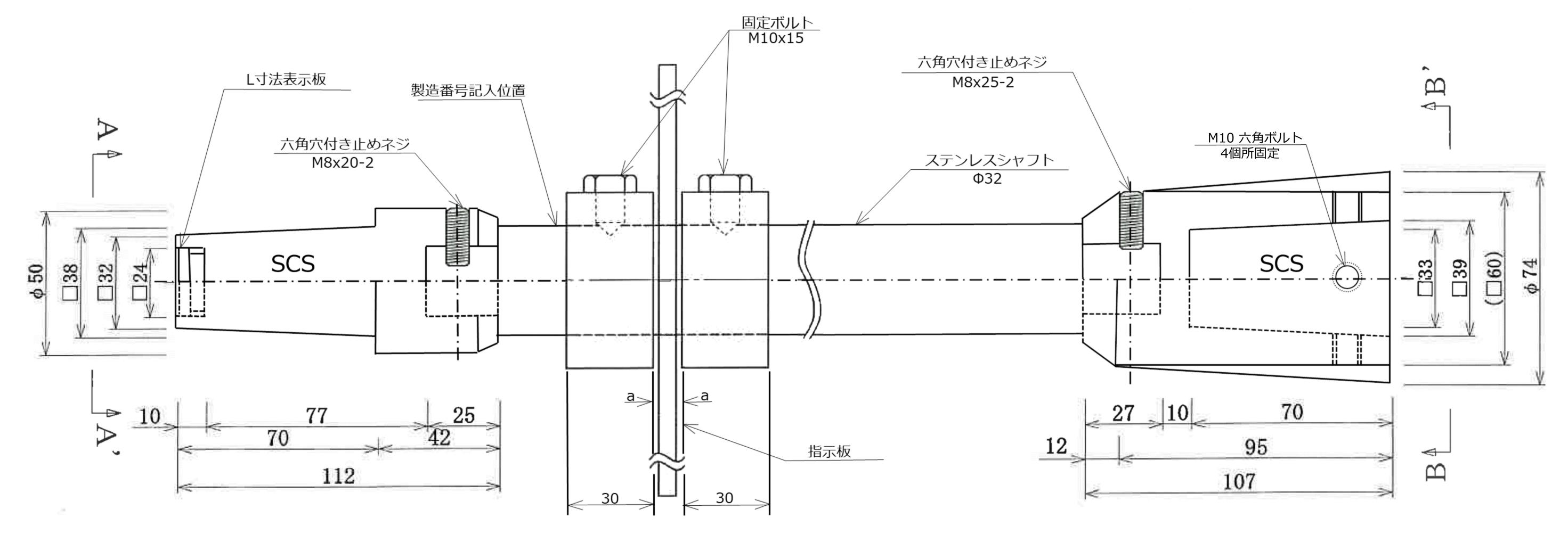
a:間隙寸法=1mm~2mm
