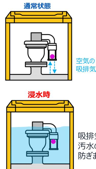
浸水時、浮き球が上昇して開口部を閉じ、汚水の侵入を防止します。
