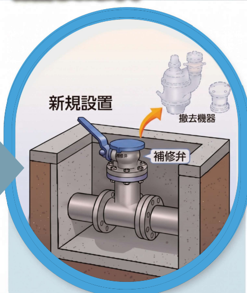
2. 空気弁・地下式消火栓を 取外し、補修弁のみの状態
